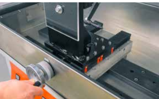
Arbeitstisch, in Y-Richtung axial verstellbar, für z.B. Laboranwendungen
