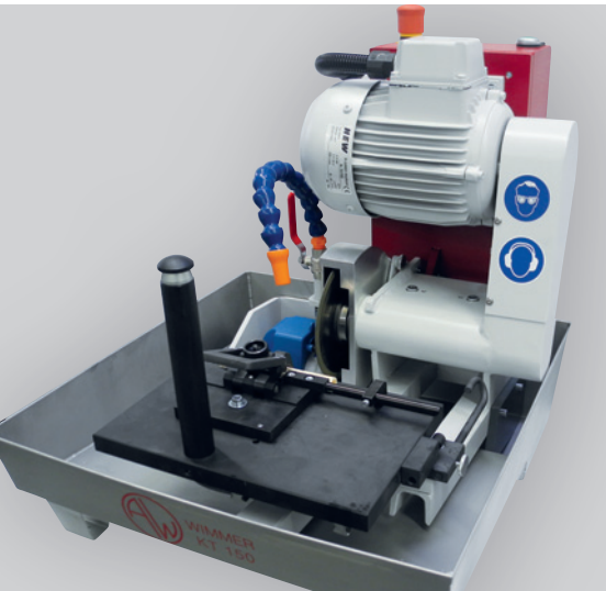
KT 150: Arbeitsbereich mit Längen- und Tiefenanschlag
